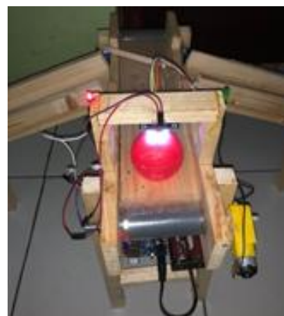
Gambar 6. Sensor warna mendeteksi dan servo berputar
