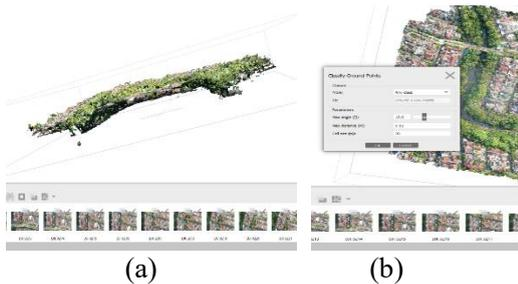
**Gambar 7.** *(a) Penghilangan Titik di Bawah Permukaan (b) Klasifikasi Titik Ground*
