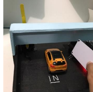
Gambar 23. Masuk Menggunakan Tag RFID
