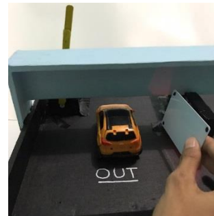
Gambar 24. Keluar Menggunakan Tag RFID
