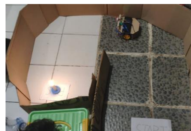
Gambar 13 Kondisi Robot saat berbelok menghindari dinding
