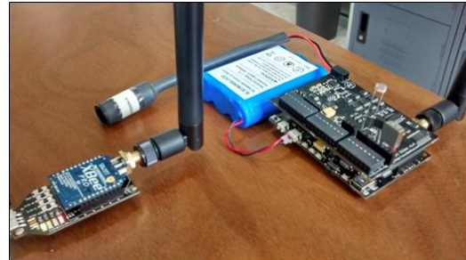
Gambar 1. Wasmote Gateway dan Smart Cities Board Terpasang pada Wasmote 802.15.4 PRO
