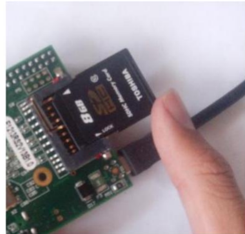
Gambar 5 Memasang Memory Card pada Raspberry Pi
