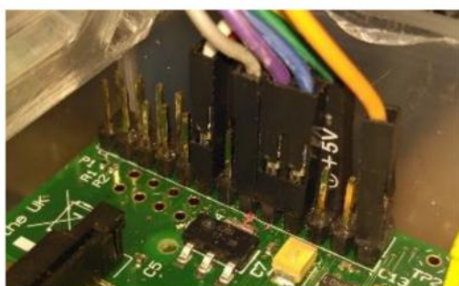
Gambar 6 Pemasangan Pin pada Raspberry Pi
