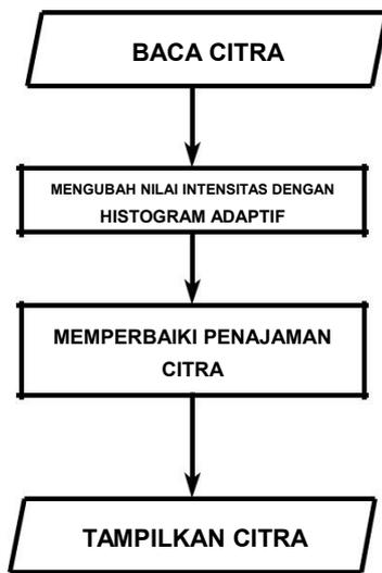
Gambar 14. Flowchart Penajaman Tepi dengan Perbaikan Intensitas Menggunakan Adaptive Histogram Equalization
