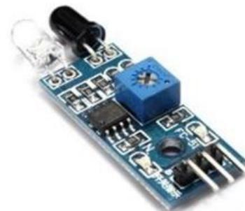
Gambar 5: Photodiode Module
