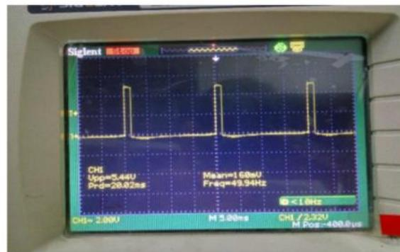
Gambar 8: Pengujian Motor servo 90°
