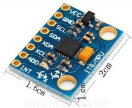
Gambar 1: sensor akselerometer
