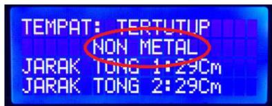
Gambar 10: Tampilan LCD Ketika Mendeteksi Sampah Nonlogam
