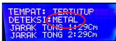
Gambar 11: Tampilan LCD Ketika Mendeteksi Sampah logam
