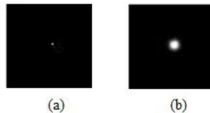
Gambar 2: Point Spread Function pada citra yang ditangkap teleskop.: (a) Citra bintang seharusnya, (b) Citra bintang yang diamati akibat distorsi PSF
