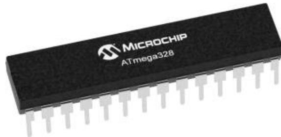
Gambar 1: Mikrokontroler Atmega 328[3].
