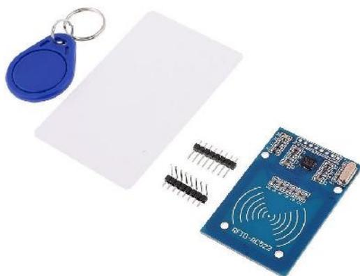
Gambar 3: Perangkat RFID [4].
