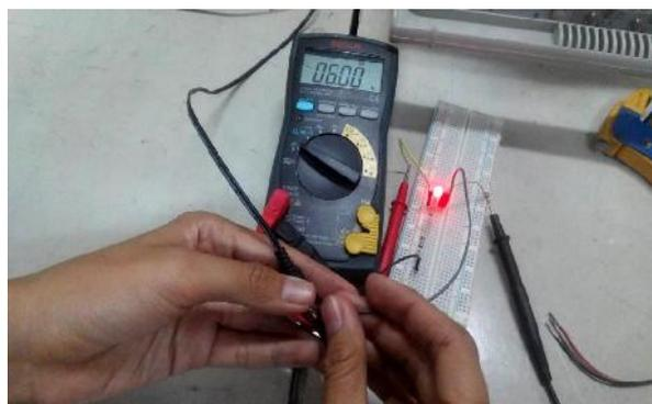
Gambar 11: Led Mendapatkan Tegangan.
