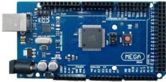
Gambar 6: Bentuk fisik Arduino Mega R3 [11]
