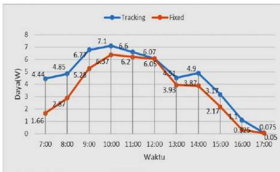
Gambar 16: Grafik Perbandingan Daya antara Metode *Solar Tracker* dengan Metode Statis
