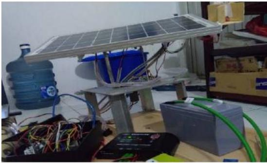
Gambar 14: Rangkaian Fisik Panel Surya dengan Sistem *Solar Tracker*
