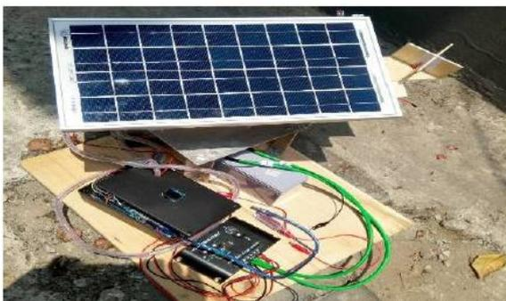
Gambar 15: Rangkaian Fisik Panel Surya dengan Sistem *Solar Tracker* saat Pengujian
