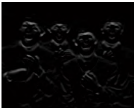
Gambar 24: Gradient Vertikal pada Citra Grayscale
