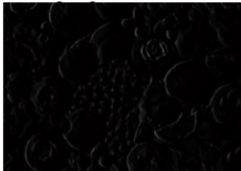
Gambar 16: Gradient horizontal yang akan digabungkan dengan gradient vertikal pada citra RGB
