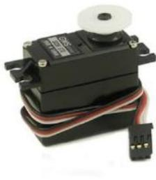
Gambar 2: Bentuk Fisik Motor Servo
