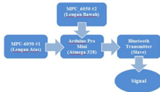
Gambar 2: Diagram Blok Sensor Gerakan
