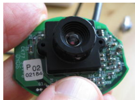
Gambar 4: Bentuk Lensa Kamera Web. [5]
